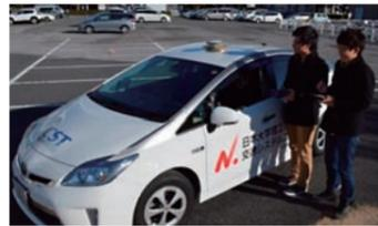
▲高精度GPS受信機搭載車両
